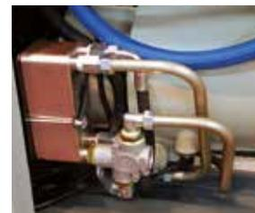
Il kit "Recupero Calore" è perfettamente integrato nel circuito di raffreddamento dell'olio, rendendo l'allestimento autonomo nel controllo della temperatura dell'olio e protetto da eventuali anomalie, quali la riduzione del flusso d'acqua e da un surriscaldamento.
